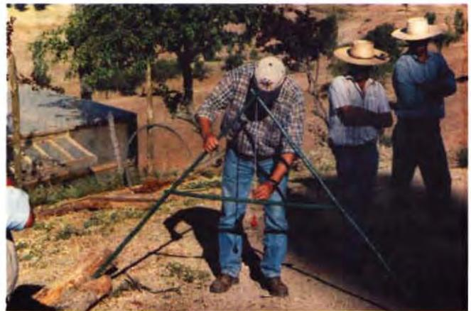
Figura 18: Nivel tipo A para marcación de curvas de nivel
