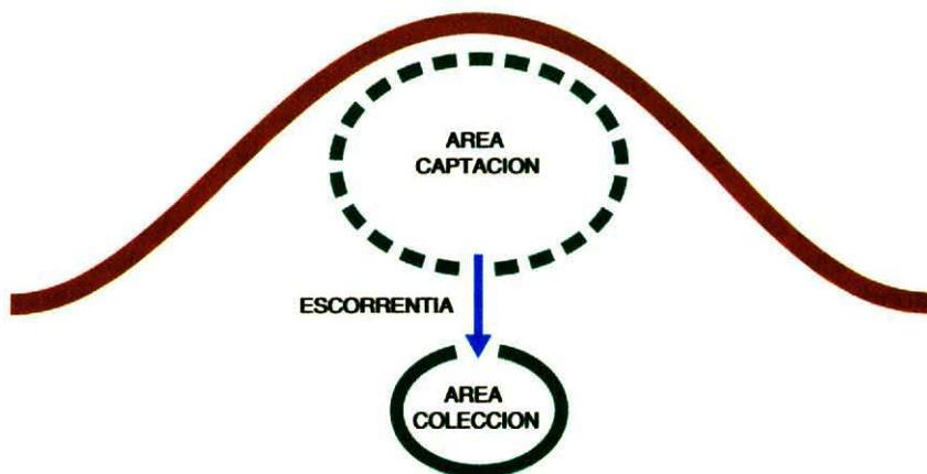
Figura 1: Esquema de la relación de magnitud de áreas en cosecha de aguas lluvia.
