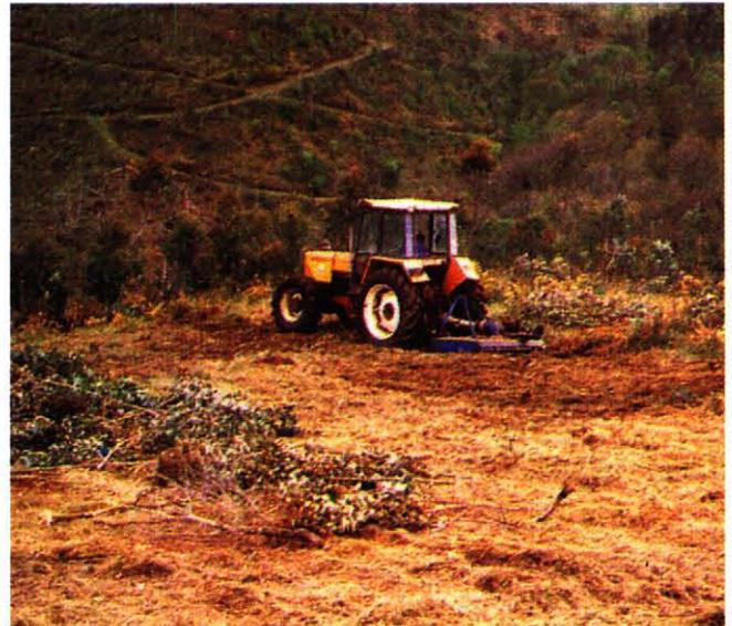
Figura 3: Tractor con mulcher Fuente:González-Río et al. Sf.
