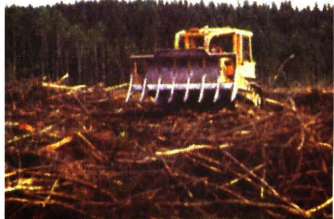
Figura 4: Ordenamiento desechos mecanizado
