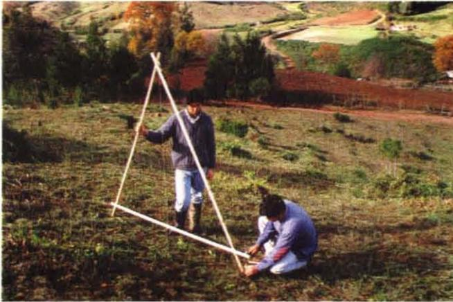
Figura 5: Marcación de curvas de nivel con nivel en A.
